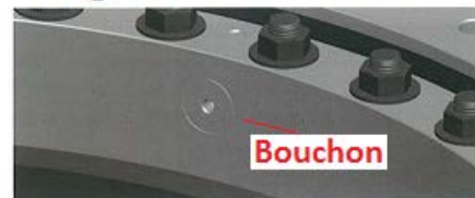
Point faible du bouchon
